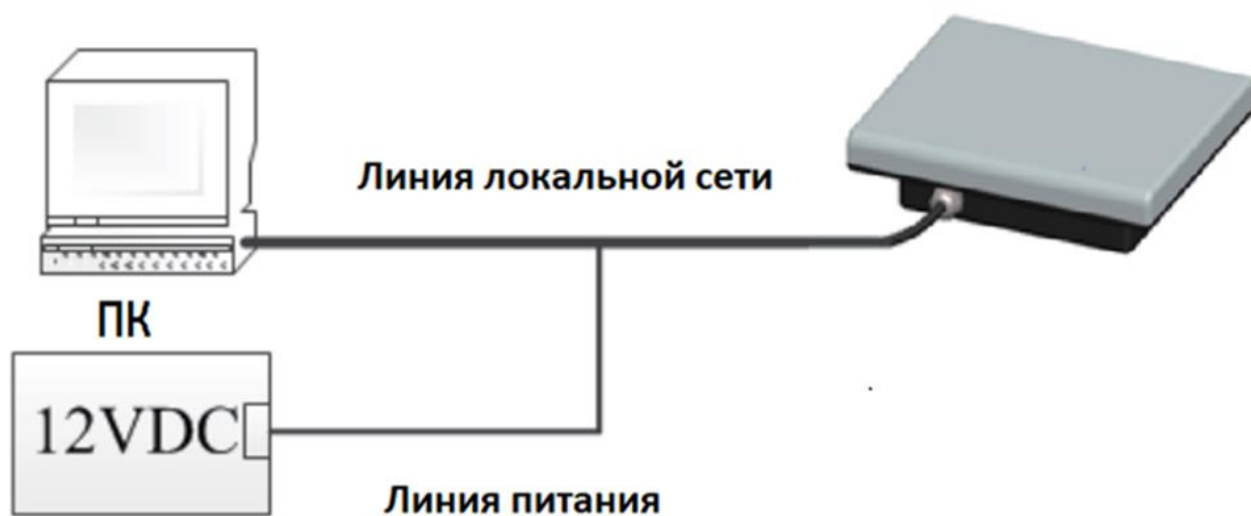
Схема подключения ПК к радару
